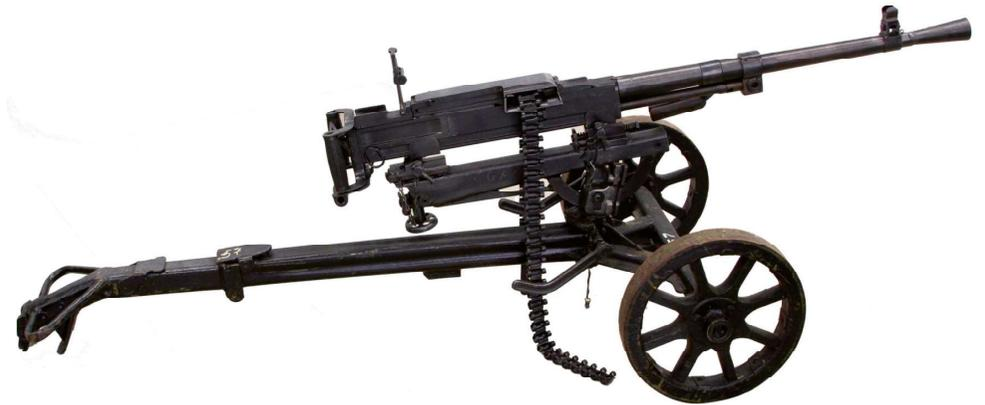
▲ Станковой пулемет Горюнова образца 1943 г. (СГ-43)
