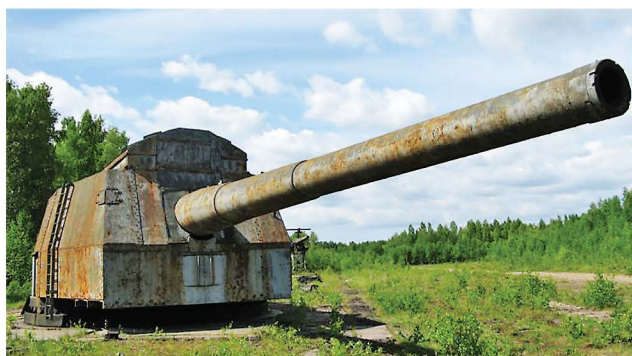
Опытная 406-мм артиллерийская установка МП-10 с пушкой Б-37
