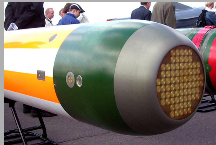
Головной отсек торпеды УГСТ с антенной бортовой ГАС, датчиками неконтактных взрывателей и антенной СН
