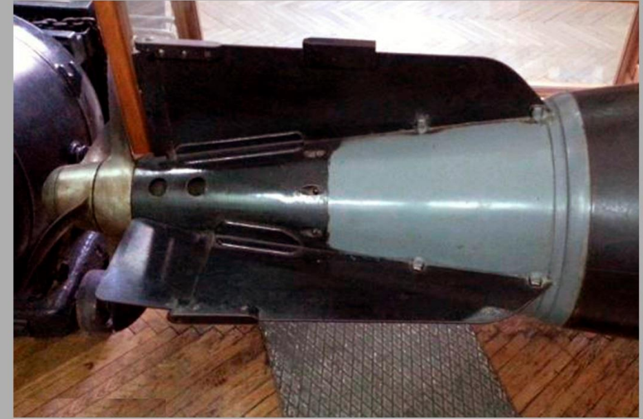
Торпеда САЭТ-50, хвостовая часть с излучающей катушкой НВ.
