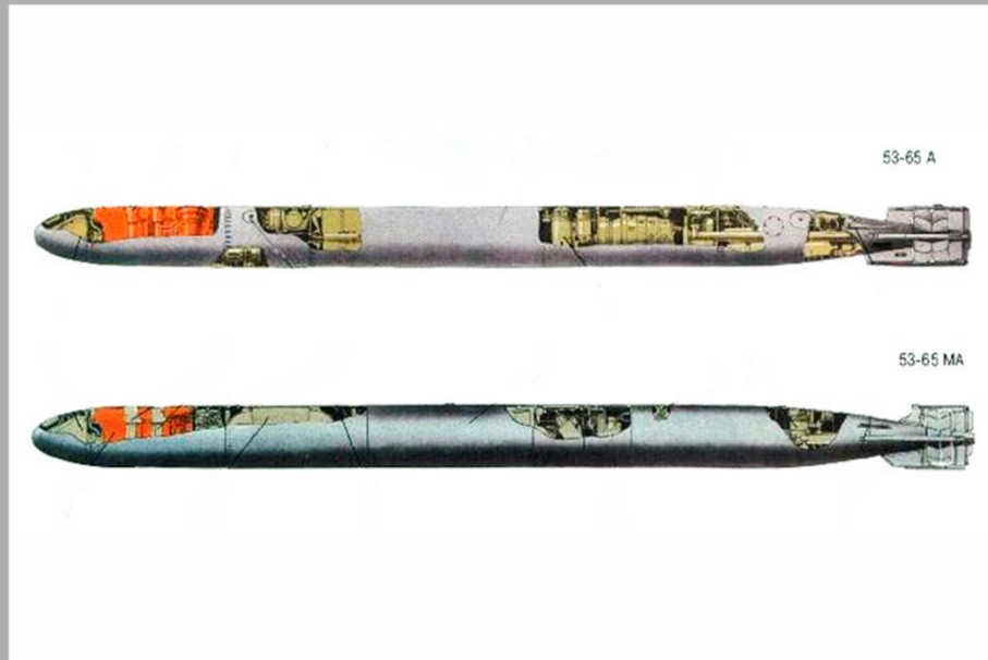
Компоновочная схема торпед 53-65А и 53-65МА
