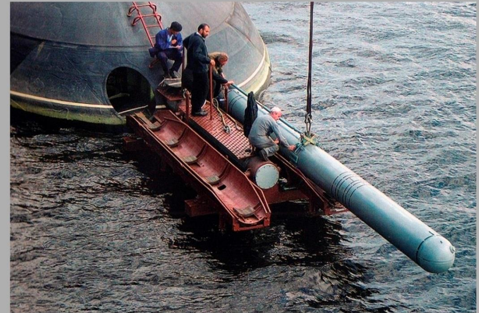
Погрузка торпеды 53-65КЭ на подводку проекта 877Э..
