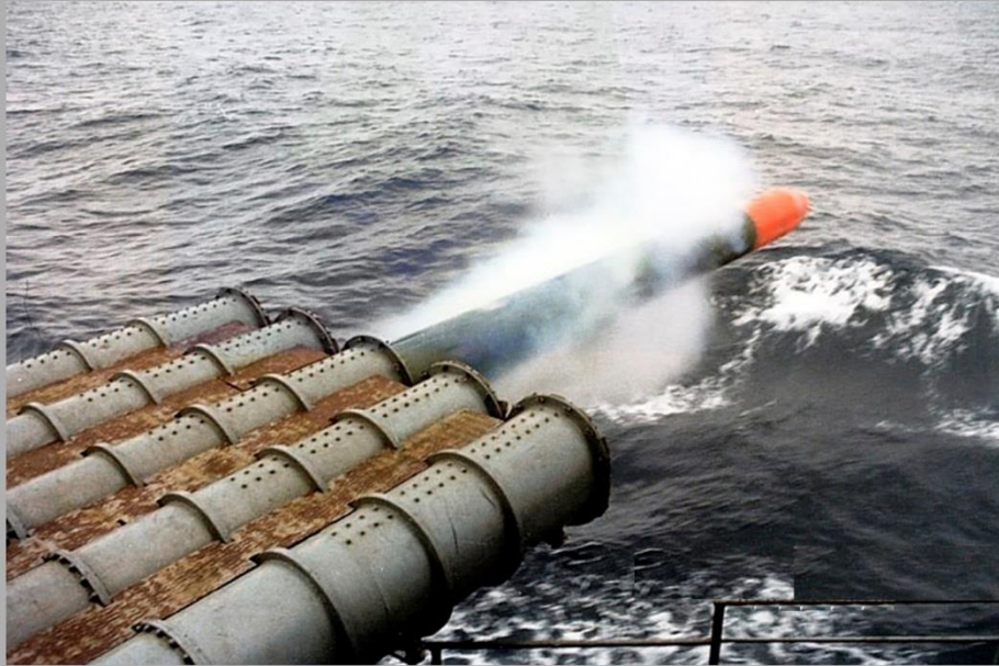
Пуск 533-мм торпеды ТЭСТ-71.
