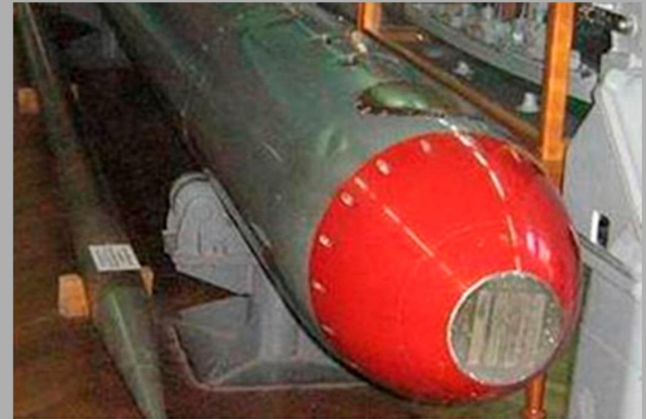
Торпеда САЭТ-50, БЗО с приемно-усилительным устройством АСН.
