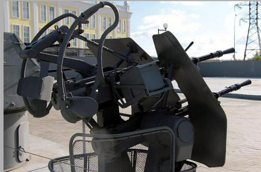
*Корабельная пулеметная установка 2М-7.*
