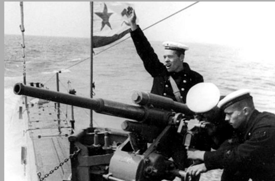
45-мм орудие 21-КМ на подводной лодке Щ-214.
