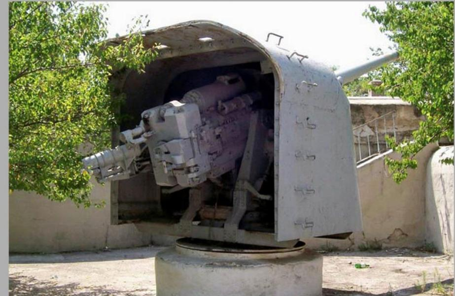
Установка Б-13 со стороны казенной части
