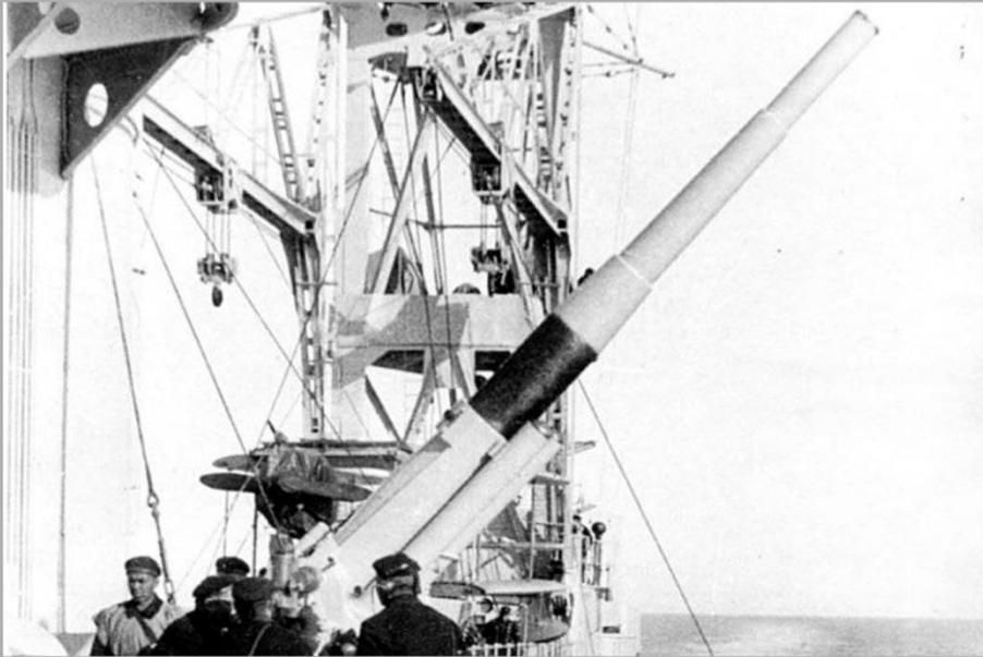
Внешний вид 102-мм корабельной пушки Б-2
