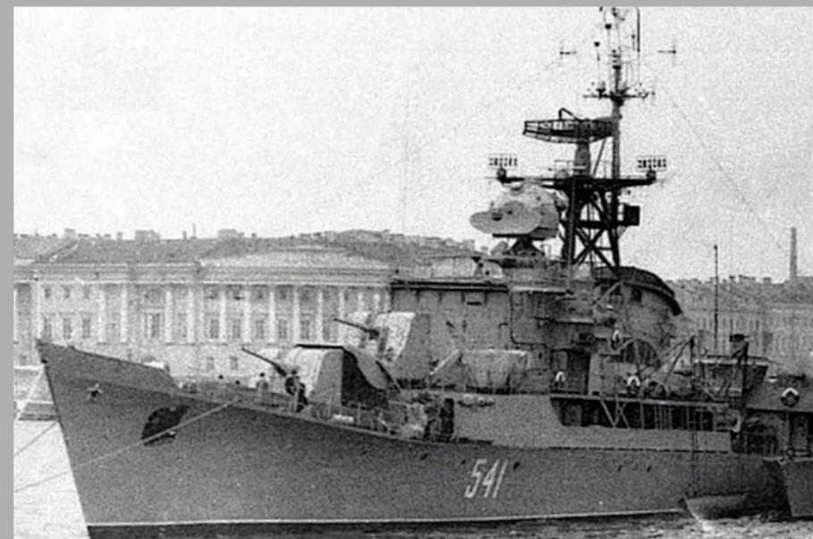
100-мм орудие Б-34 на сторожевом корабле проекта 50.
