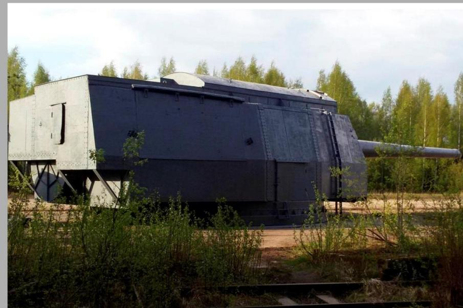
406-мм орудие Б-37 в экспериментальной установке.
